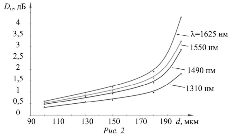
Наиболее значительное ослабление мощности на всех длинах волн наблюдается при  $\lambda=1625$  нм. Это является следствием того, что при увеличении длины волны увеличивается диаметр модового пятна, а следовательно, и его площадь. При увеличении площади модового пятна большая часть распространяющегося по волокну в области микроизгиба излучения переходит в оболочку оптического волокна и покидает его через боковую поверхность.
